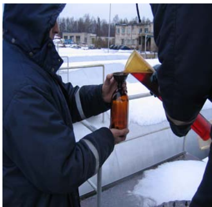
Naftas produktu parauga izņemšana kvalitātes pārbaudei mobilajā ekspreslaboratorijā
